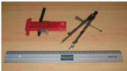
Matériel : 1 règle, un compas ( de préférence équipé d'une vis de blocage pour maintenir un diamètre constant), un cutter compas
