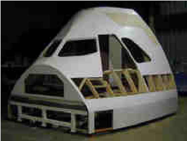
Maquette à taille réelle de la cabine de pilotage de l'A380
