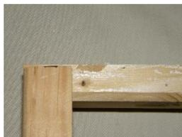
Il faut ensuite prendre le deuxième support et le clouer sur l'autre face des baguettes, aligné sur l'autre extrémité.
